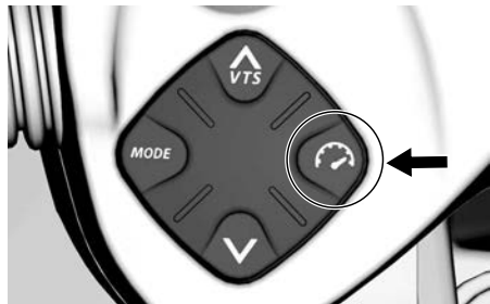
TYPIQUE - BOUTON START/STOP DU MOTEUR
