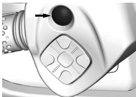
TYPIQUE - BOUTON START/STOP DU MOTEUR
