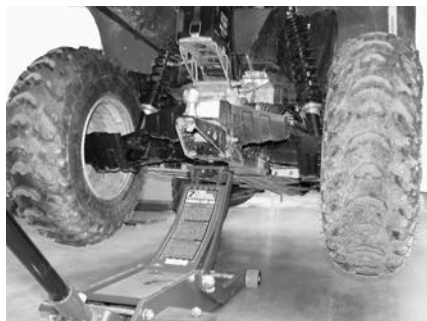
CONFIGURAZIONE TIPICA - PUNTO DI SOLLEVAMENTO POSTERIORE
