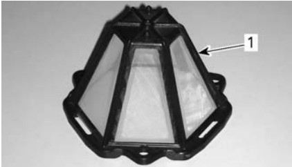
1. CVT:n ilmansuodatin (kiinnitettävä suodatin)
