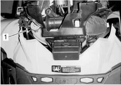
1. Réservoir du liquide de refroidissement
