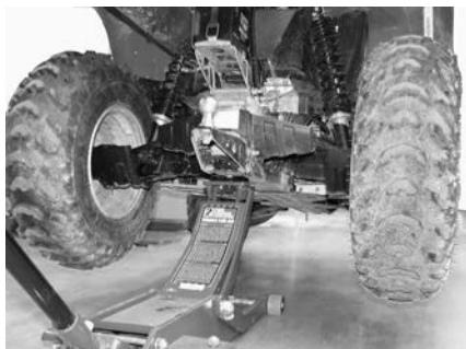
TYPIQUE — POINT DE LEVAGE ARRIÈRE
