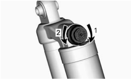
SMORZAMENTO IN COMPRESSIONE - PARTE SUPERIORE DELL'AMMORTIZZATORE
