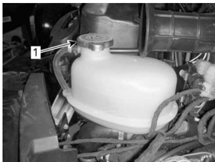
1. Tappo del serbatoio liquido refrigerante motore
