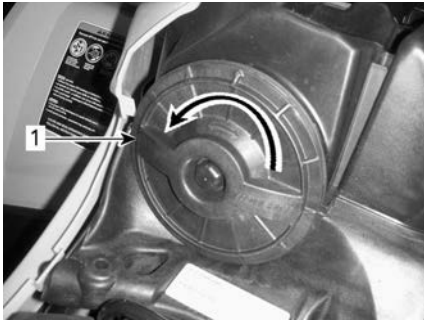
1. Couvercle du filtre à air
