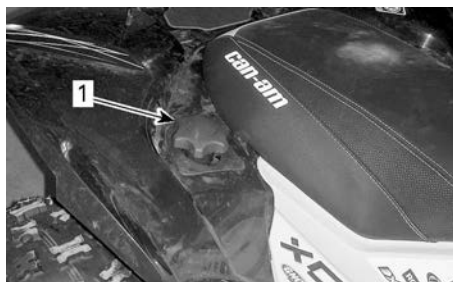
1. Bouchon de réservoir d'essence
