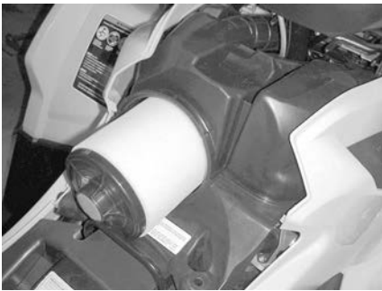
1. Couvercle du filtre à air
