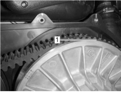
1. Parte inferior de los dientes a la altura de la superficie externa de la correa conductora
