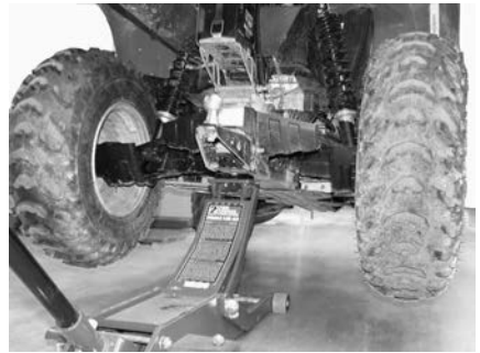
TÍPICO: PUNTO DE ELEVACIÓN TRASERO
