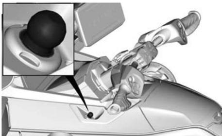
若要让发动机起动，则必须牢固地将紧急熄火拉绳安装到发动机熄火开关上。
