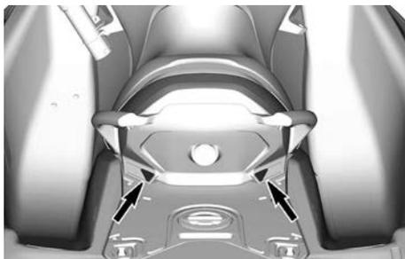
2. 然后拉起闩锁手柄，拆下摩托艇上的前部座椅。
