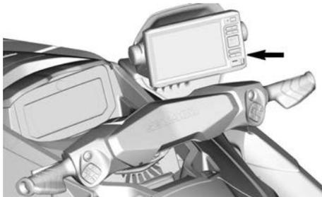
要拆下声纳，请提起锁定片并断开电接插件。
