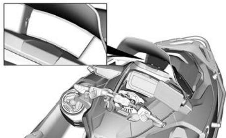
挡风玻璃安装在快速拆装系统上，如果与操作员发生碰撞，它将向前倾斜。
