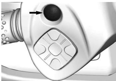
典型示例 - 发动机 START/STOP (启动 / 停止) 按钮
