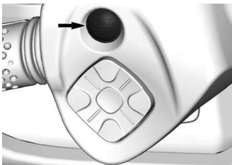
TÍPICO – BOTÃO START/STOP DO MOTOR (PARTIDA/PARADA)
