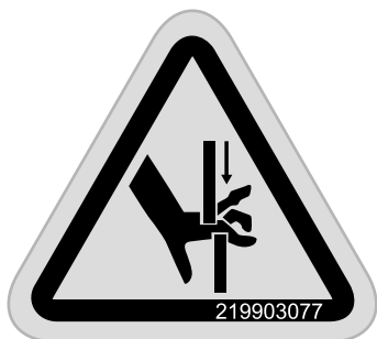
REVERSOR DO IBR - ETIQUETA DE ADVERTÊNCIA
