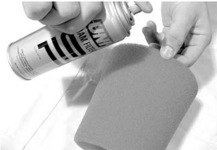
TYPIQUE - HUILER LE FILTRE EN MOUSSE
