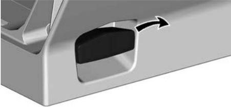
2. Levante o acessório para remover do bloco.
