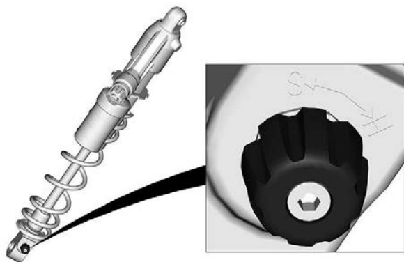
1. Dispositif de réglage de l'amortissement des rebonds
