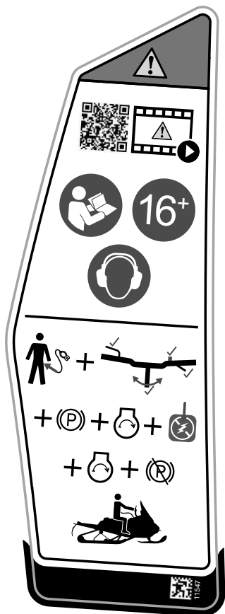
PROCEDURA DI AVVIAMENTO – ETICHETTA DI AVVERTENZA (PITTO)
