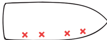
Mauvaise répartition (trop chargée à tribord) KC-1340.1
