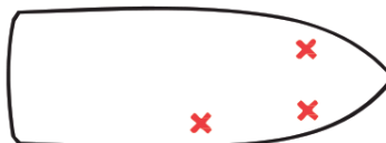
Mauvaise répartition (trop chargée sur l'étrave) KC-1330.1
