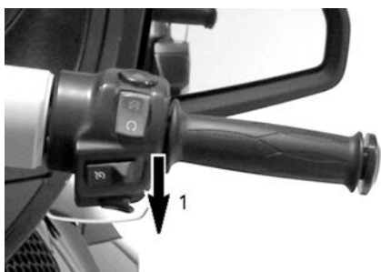
1. Appuyez vers le bas pour réduire la vitesse réglée
