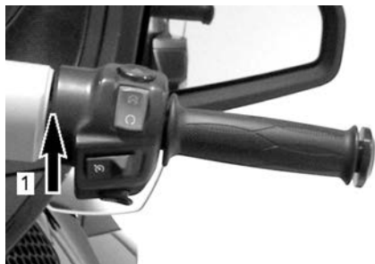
1. Työnnä painiketta ylöspäin palauttaaksesi (JATKA) vakionopeuden säätimen
