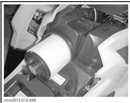
REMOÇÃO DO FILTRO DE AR
