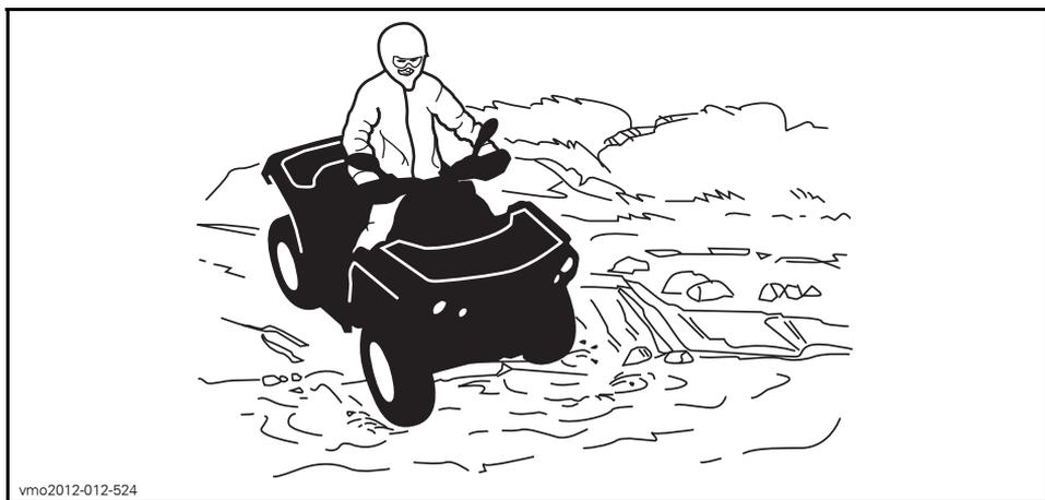
A água afeta a capacidade de frenagem do seu veículo. Certifique-se de secar os freios, aplicando-os várias vezes depois de sair da água. Considerar uma distância maior para frenagem.
