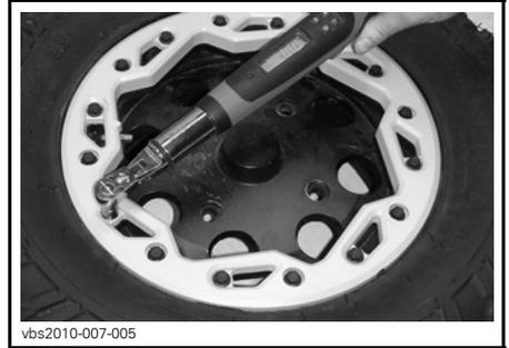
**NOTA:** É normal que o anel de aperto da trava de talão flexione ligeiramente para encaixar no talão do pneu.
