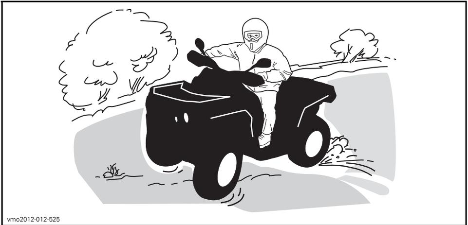
Se você deslizar ou derrapar, virar o guidão na direção do movimento pode ajudar a recuperar o controle do veículo. Nunca frear com força e travar as rodas.
