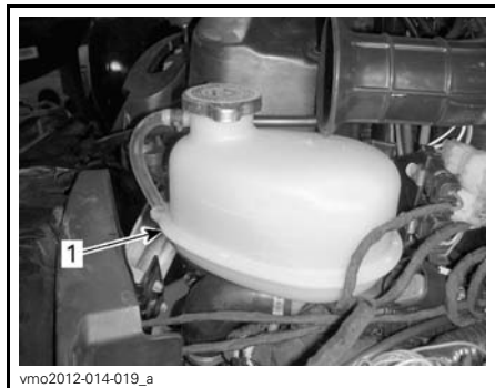
1. Réservoir de liquide de refroidissement
