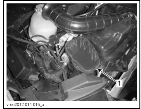
1. Filtre à air de la transmission CVC
