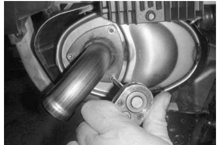
TYPEBILDE – FJERNING AV UTBLÅSINGSRØR
