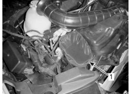
1. Filtro de aire de la CVT
