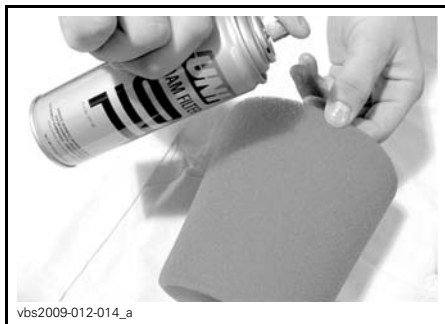
TYPIQUE - HUILER L'ÉLÉMENT EN MOUSSE
