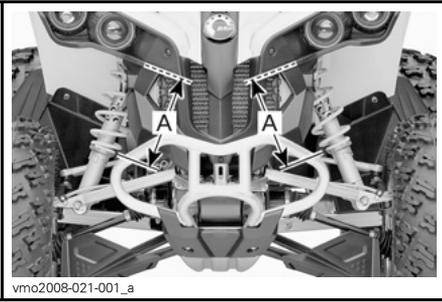
**TÍPICO — AJUSTE DE PRECARGA EN LA PARTE DELANTERA**
