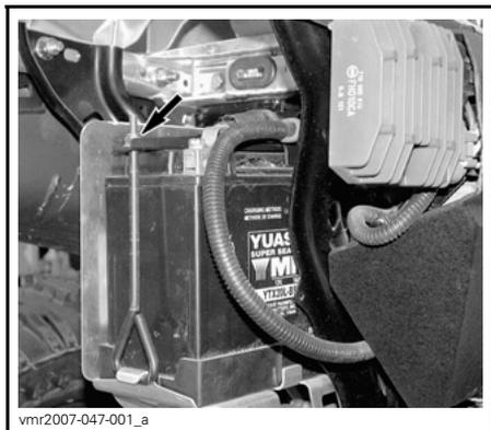
Tire hacia afuera del soporte de la parte superior.
