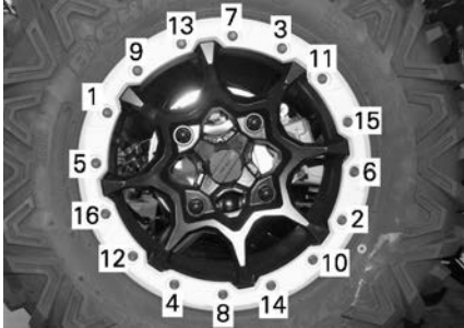
TYPISCH - AANDRAAIVOLGORDE
