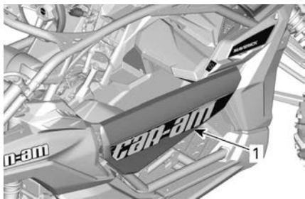
1. Puerta cerrada y correctamente bloqueada.
