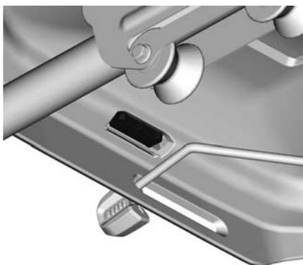
Понявие вверх заднюю часть подушки, а затем снимите ее с каркаса сиденья, потянув назад.
