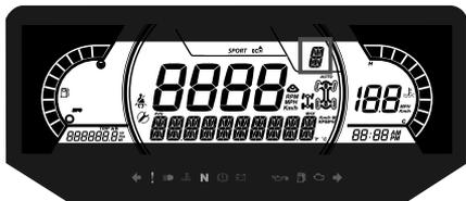
Отображает положение передач:
