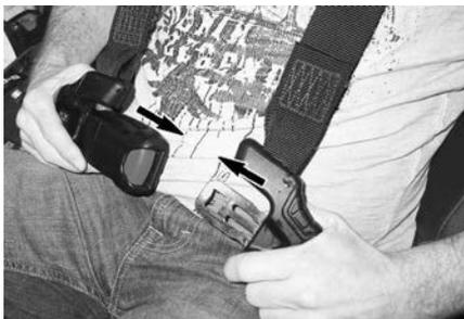
С обеих сторон отрегулируйте плотность прилегания ремня к телу, потянув свободные концы поясного ремня внутрь. Защелка должна быть отцентрирована на уровне линии талии (как можно ниже).
