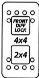
Остановите транспортное средство и не выключайте двигатель. С помощью этого переключателя вы можете менять режим с двух ведущих колес на полный привод.
