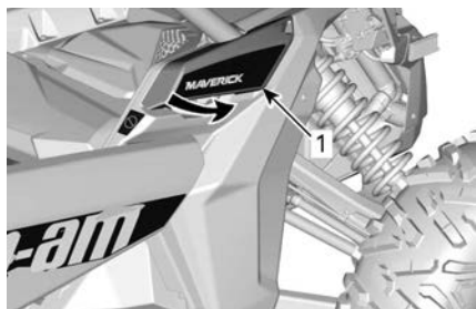
1. Cobertura da tampa do reservatório de combustível
