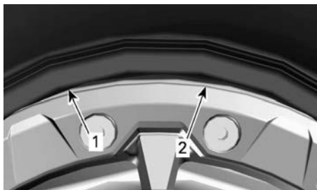
TÍPICO - TALÃO EXTERNO DO PNEU
