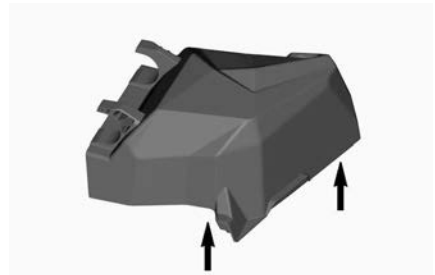
LEVANTAR A PARTE TRASEIRA DA TAMPA DE MANUTENÇÃO
