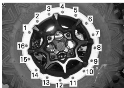
TYPIQUE - SÉQUENCE DE SERRAGE FINAL
