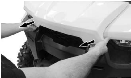
TIRARE DAL BORDO COPERCHIO DI MANUTENZIONE ANTERIORE.
