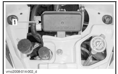
1. Caja de fusibles en la parte delantera
