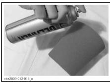
TYPICAL - SPRAY THE FOAM ELEMENT INSIDE AND OUT
