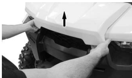
LEVANTAMIENTO DEL BORDE DE LA TAPA DE ACCESO DELANTERA.
