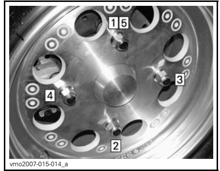
REIHENFOLGE BEIM ANZIEHEN
