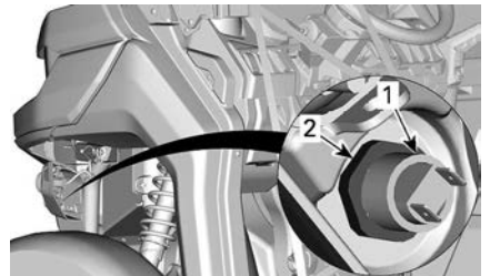
1. Габаритные огни 2. Стопорная гайка
