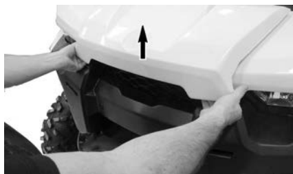
LEVER LE BORD DU COUVERCLE D'ENTRETIEN AVANT.
