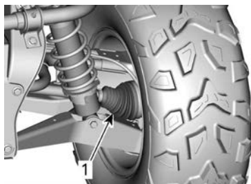
1. Soufflets d'arbre de transmission extérieur
