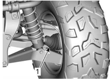
1. Fuelles exteriores del eje motriz
