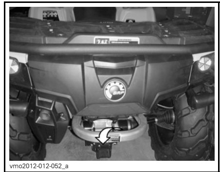
TÍPICO - LOCALIZAÇÃO DO PONTO DE SUJEIÇÃO TRASEIRO
