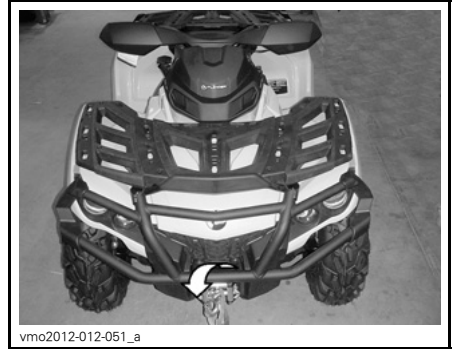
TÍPICO - LOCALIZAÇÃO DO PONTO DE SUJEIÇÃO DIANTEIRO
