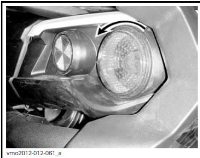
以反时针方向转动尾灯来拆卸
