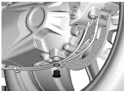
5. Выверните пробку заливного отверстия.
