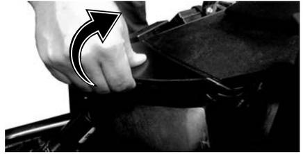
5. Потяните переднюю панель облицовки вперед, чтобы снять ее с родстера.
