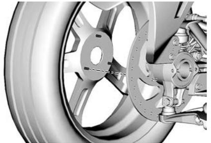
2. Установите коническую шайбу и центральную гайку крепления колеса.
