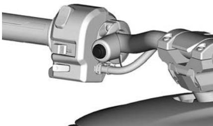
Аварийную сигнализацию можно включить в любой момент даже при неработающем двигателе. Длительное включение аварийной сигнализации приведет к разрядке аккумулятора.
