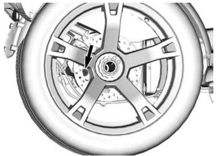
1. Поворачивайте заднее колесо до тех пор, пока пробка заливного отверстия не станет доступна через отверстие дискового тормоза.
