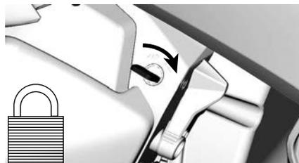
Чтобы разблокировать рычаг стояночного тормоза, поверните ключ против часовой стрелки.
