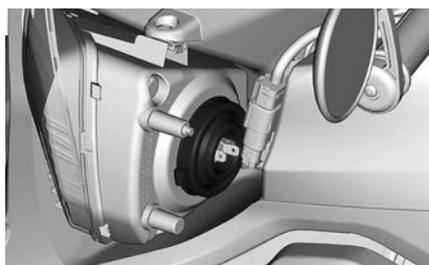
4. Поверните фиксатор лампы против часовой стрелки, чтобы отсоединить её.
