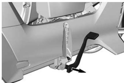
4. フットペグを下げ、ドライバーがブレーキペダルを作動範囲全体にわたって踏み込めることを確認します。
