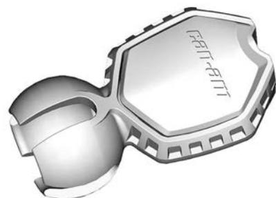
各キーには、エンジンを起動させるためにあらかじめプログラムされ、無線周波数を通じてイモビライザーシステムによって読み取られる電子回路が含まれています。
