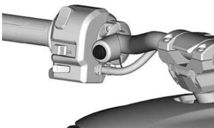
クルーズコントロールにより、車両走行中に一定の速度を保つことが可能になります。必要に応じてエンジン速度を上げ下げします。
