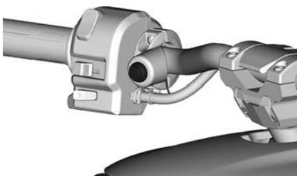
ハザード警告点滅灯は、エンジンが作動していないときにも作動させることが可能です。点滅灯を長時間使用すると、バッテリーを消耗させることになります。
