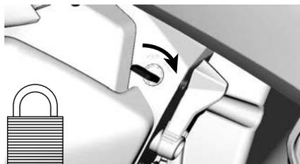
パーキングポジションレバーのロックを解除するには、キーを反時計方向に回します。
