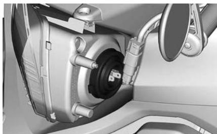
4. バルブストッパーを反時計方向に回してロックを解除します。
