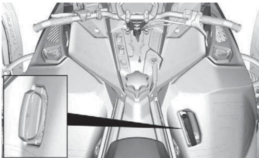
A riavvolgimento automatico, posizionata sul lato destro della motoslitata. Per inserire il meccanismo, tirare lentamente la maniglia fino a quando non si percepisce una resistenza, quindi tirare con forza. Rilasciare lentamente la maniglia.
