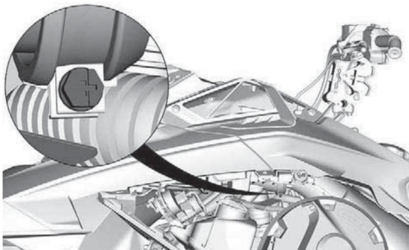
9. Rimuovere le viti di fissaggio del modulo superiore della scocca su entrambi i lati.
