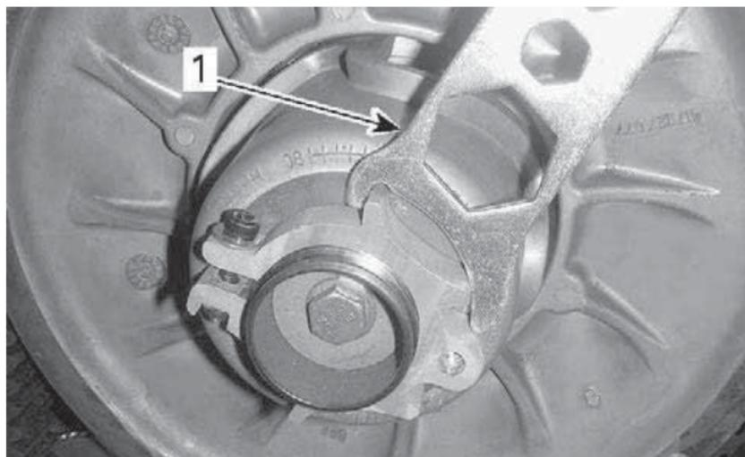
1. Strumento di regolazione delle sospensioni
