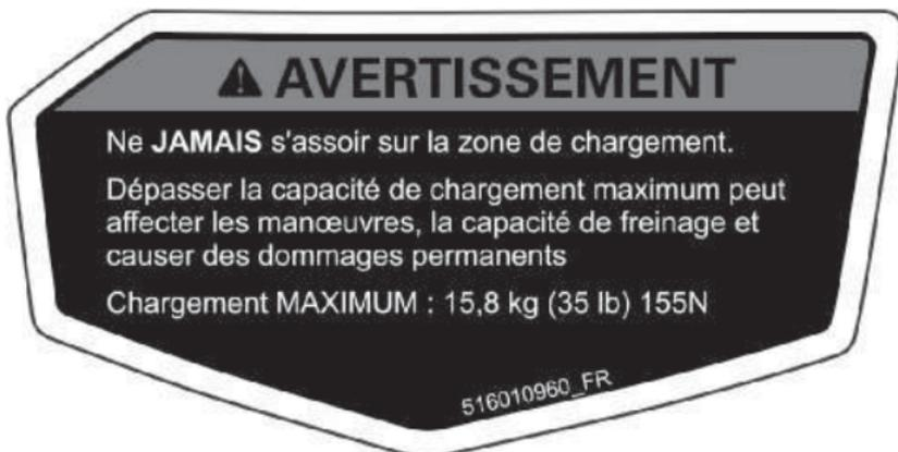
**CAPACITÉ DE CHARGE MAXIMALE - ÉTIQUETTE D'AVERTISSEMENT**
