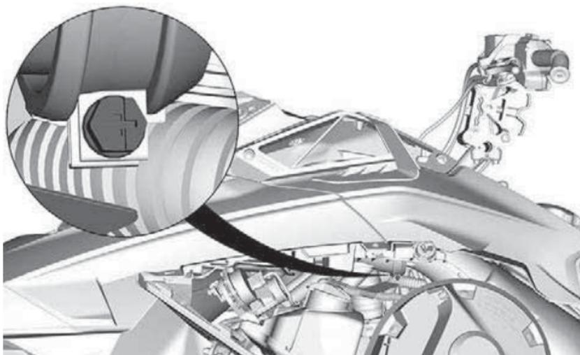
9. Entfernen Sie die Halteschrauben des oberen Karosseriemoduls auf beiden Seiten.
