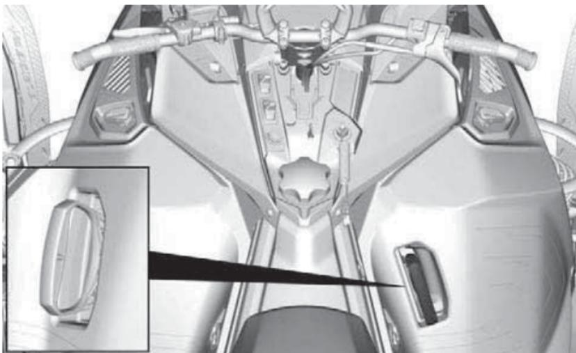
Hierbei handelt es sich um einen Startgriff mit automatischer Aufwicklung, der sich an der rechten Seite des Motorschlittens befindet. Zum Betätigen des Mechanismus ziehen Sie langsam am Griff, bis Sie einen Widerstand spüren. Ziehen Sie dann energisch und kraftvoll. Geben Sie den Griff langsam wieder frei.
