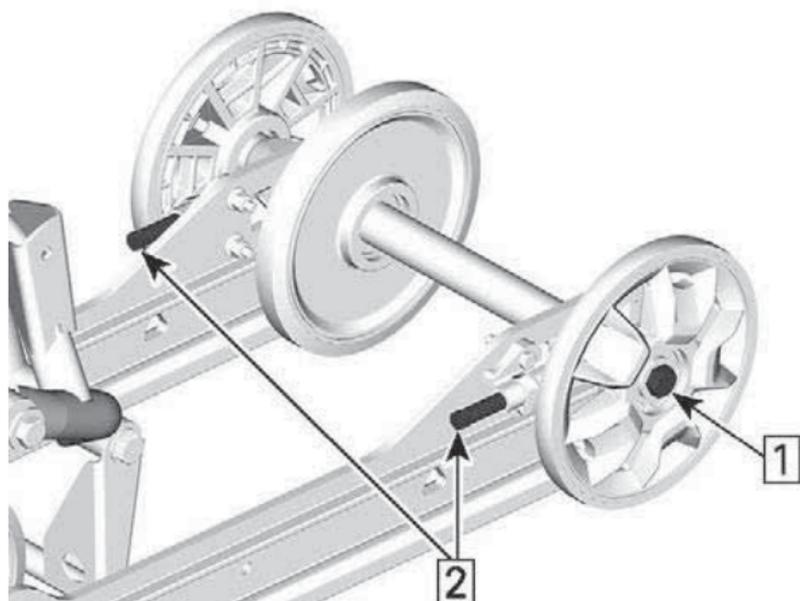
1. Lösen Sie die Achsschrauben.
