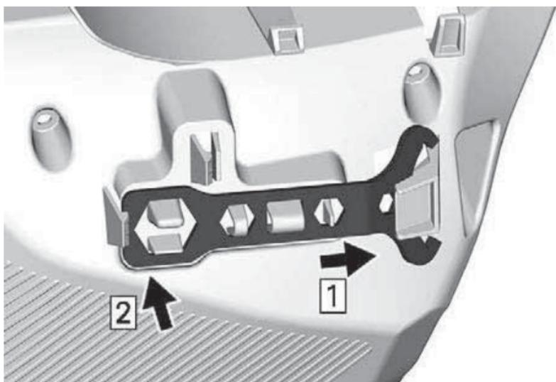
3. Schieben Sie den Scheiben-Expander und die Scheinwerfereinstellvorrichtung am kurzen Ende in das Loch.
