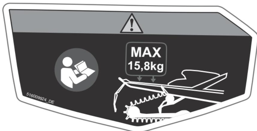
**MAXIMALE ZULADUNG UND ZUGLAST – WARNSCHILD**
