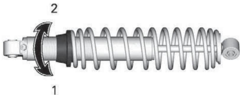
1. Vorspannung erhöhen
