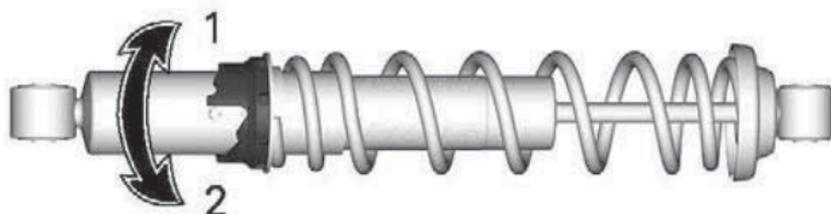
1. Vorspannung erhöhen
