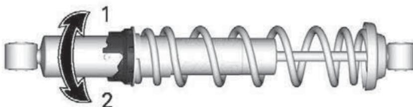
1. Vorspannung erhöhen
