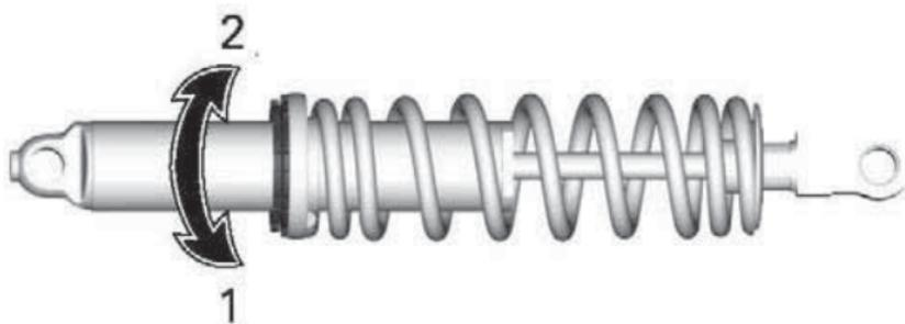
1. Vorspannung erhöhen
