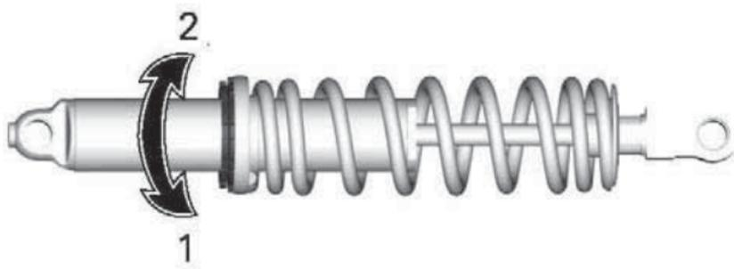
1. Vorspannung erhöhen
