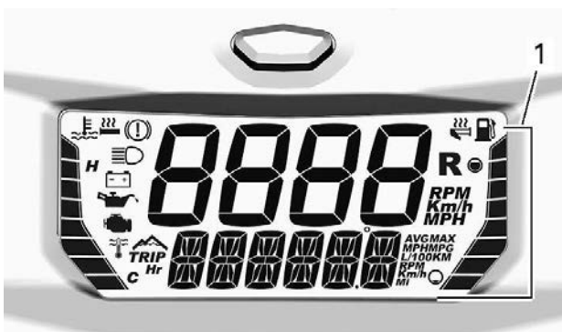
1. Søylemåler høyre side
