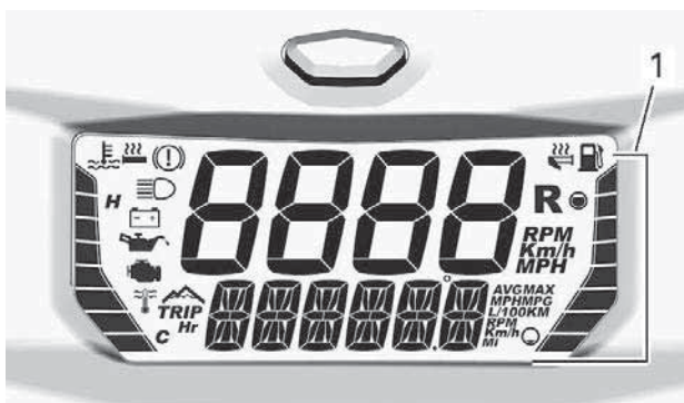
1. Søylemåler høyre side
