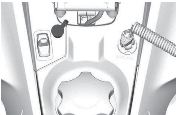
ドライバー側の電動バイザージャックコネクターの位置
