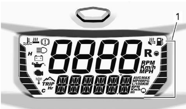
1. Søylemåler høyre side
