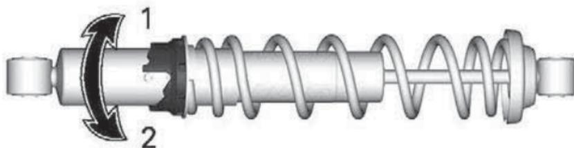
1. Vorspannung erhöhen
