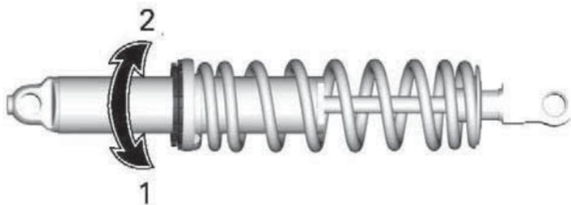
1. Vorspannung erhöhen
