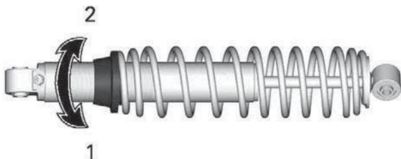
1. *Vorspannung erhöhen*
