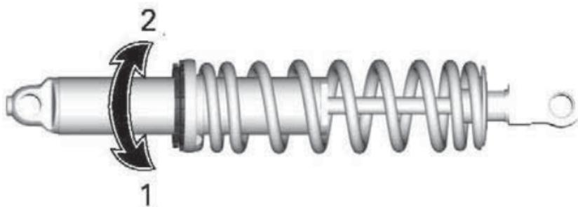
1. Vorspannung erhöhen
