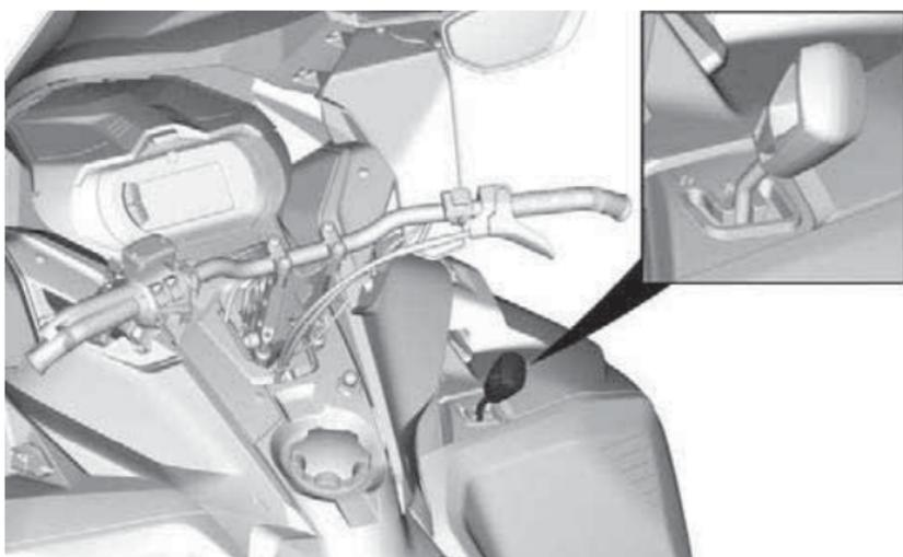
Wählen Sie mit diesem Hebel die Gänge. Das Getriebe hat zwei Vorwärtsgänge und einen Leerlauf.
