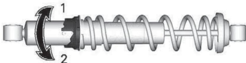
1. *Vorspannung erhöhen*
