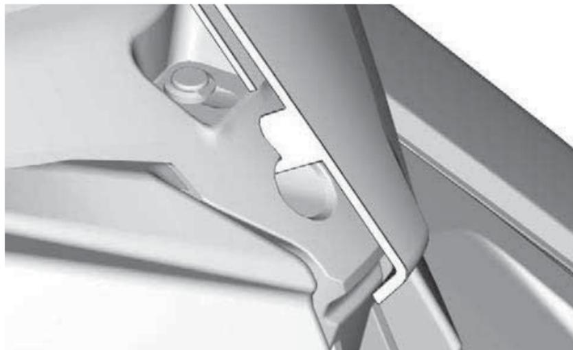
3. Fixez le pare-brise en insérant les goupilles du pare-brise dans les œilletons.
