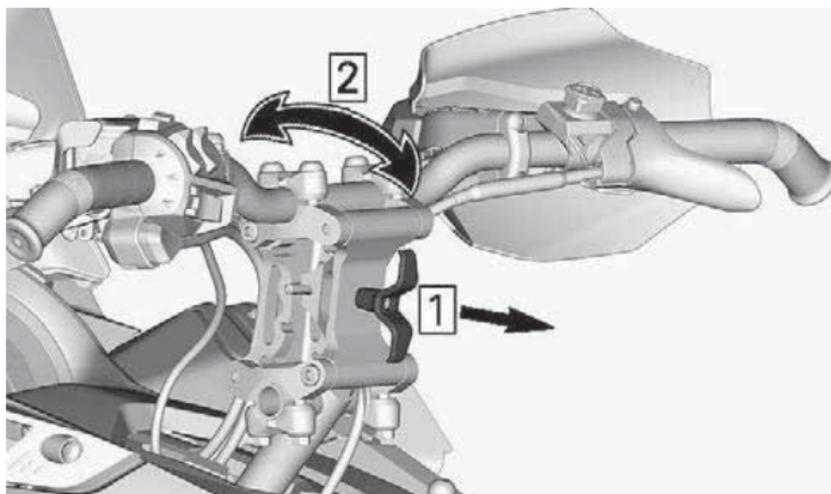
Déplacer le guidon de l'avant vers l'arrière pour s'assurer que le mécanisme est bien engagé.
